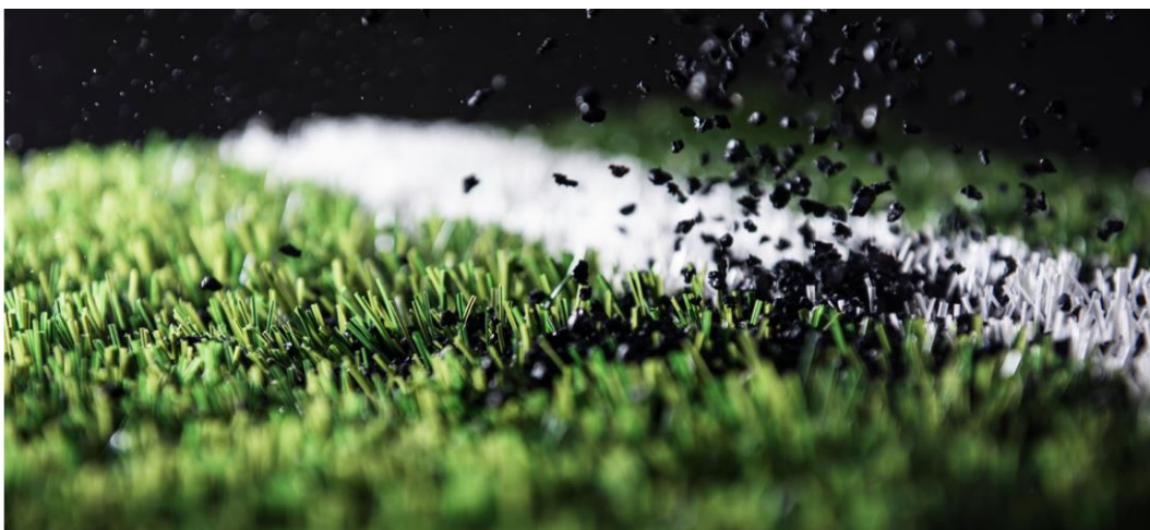
Figur 3-2. Gummigranulat på konstgräsplan (Bild från Unisport)
