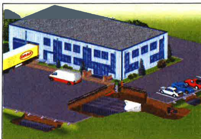
Figur 6. Exempel på utjämningsmagasin bestående av dagvattenkassetter (Uponor)
