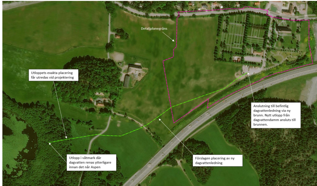
Figur 9. Förslagen placering av ny utloppsledning för dagvatten från Botkyrka kyrkogård.
