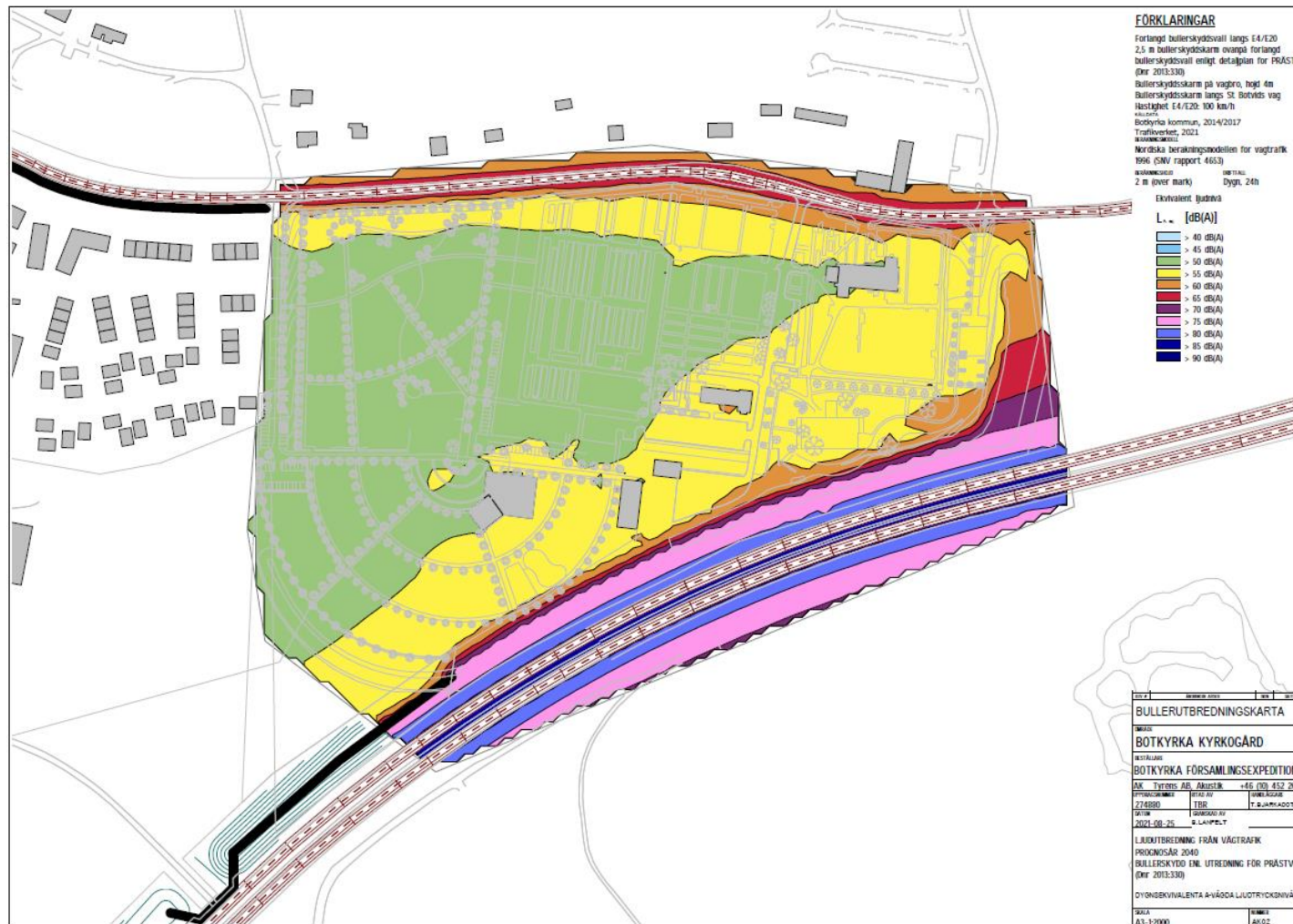
Figur 63. Ljudutbredning från vägtrafik. Prognosår 2040. Bullerskydd enligt utredning för Prästviken. Illustration ur Tyréns trafikbullerutredning 2021-09-06.
