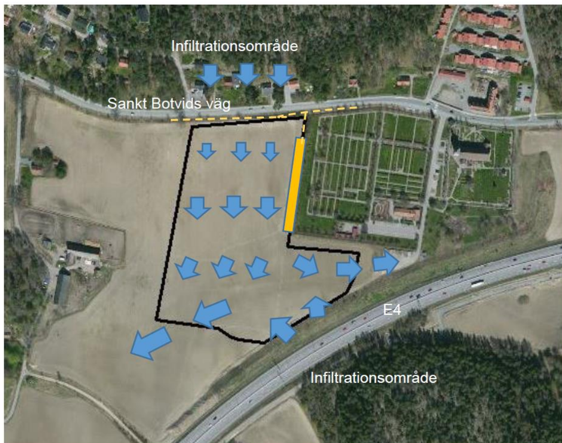
Figur 51. Grundvattenströmningsriktning av grundvattnet i friktionsjorden (blå pilar) vägdike längs Sankt Botvids väg (gul streckad linje) och "stenkistan" (gul rektangel). Illustration ur PM Hydrogeologi, Bjerking 2016-08-17.
