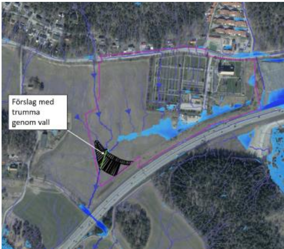
Figur 45. Skyfallsanalys vid 50 mm med planerad vall med trumma genom vällen.
