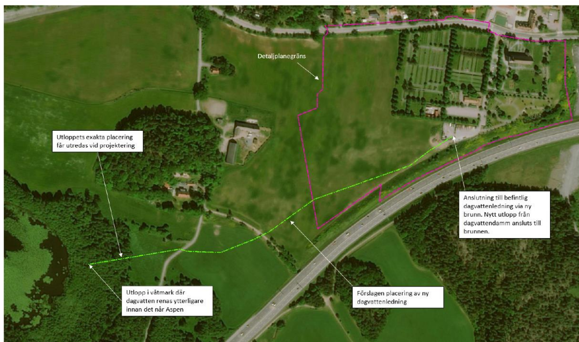
Figur 37. Föreslagen placering av ny utloppsledning för dagvatten från Botkyrka kyrkogård.
