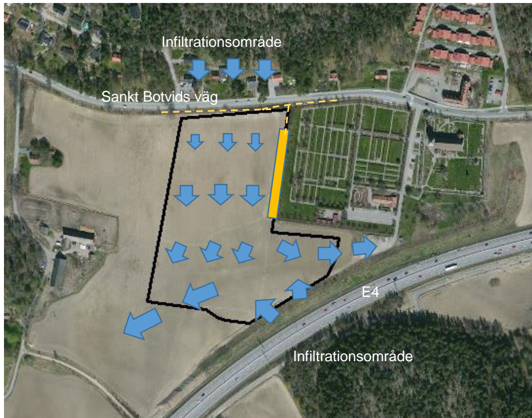
Figur 3: Grundvattenströmningsriktning av grundvattnet i friktionsjorden (blå pilar), vägdike längs Sankt Botvids väg (gul streckad linje) och "stenkistan" (gul rektangel).
