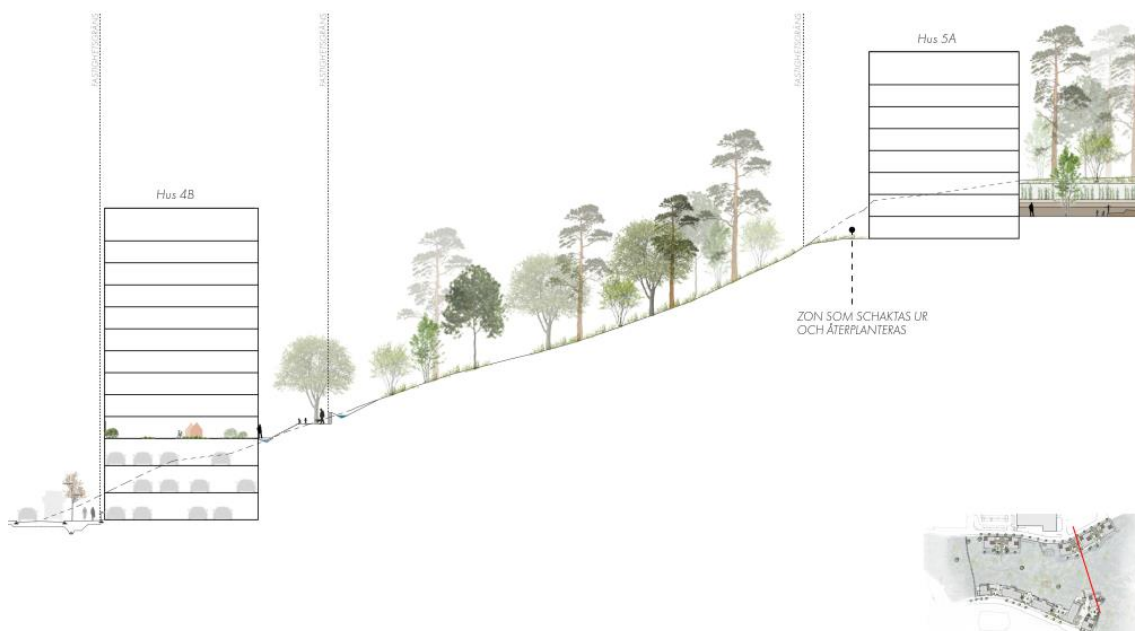
Figur 8 Sektion genom östra delen av planområdet mellan Bryggargvägen till vänster och Harbrovägen till höger. Sektionens läge markerat med röd linje i figuren till höger.
