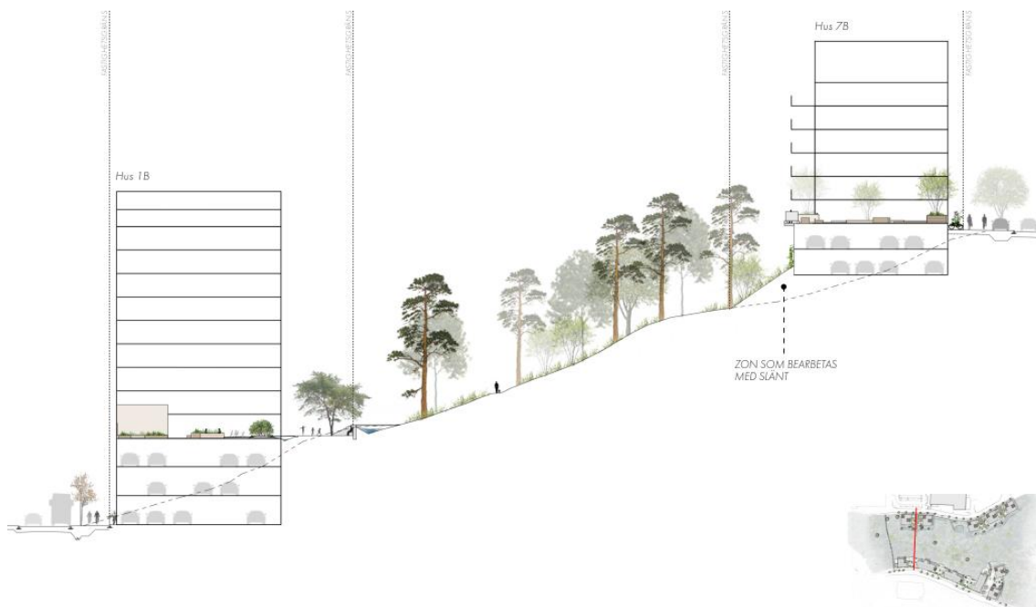
Figur 7 Sektion genom västra delen av planområdet mellan Bryggargvägen till vänster och Harbrovägen till höger. Sektionens läge markerat med röd linje i figuren till höger.
