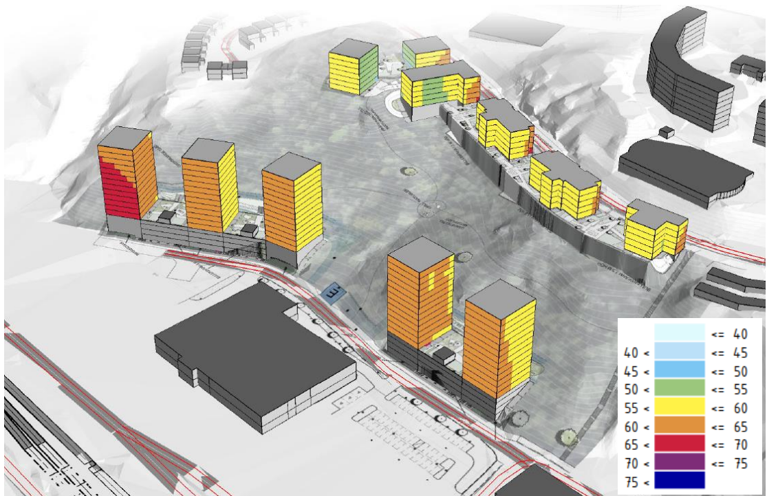
Figur 26. Maximala ljudnivåer från väg- och spårtrafik vid fasad från väg och järnväg med vy från nordväst, prognosår 2040. Frifältsvärden vid fasad (Tyréns AB, 2019a).
