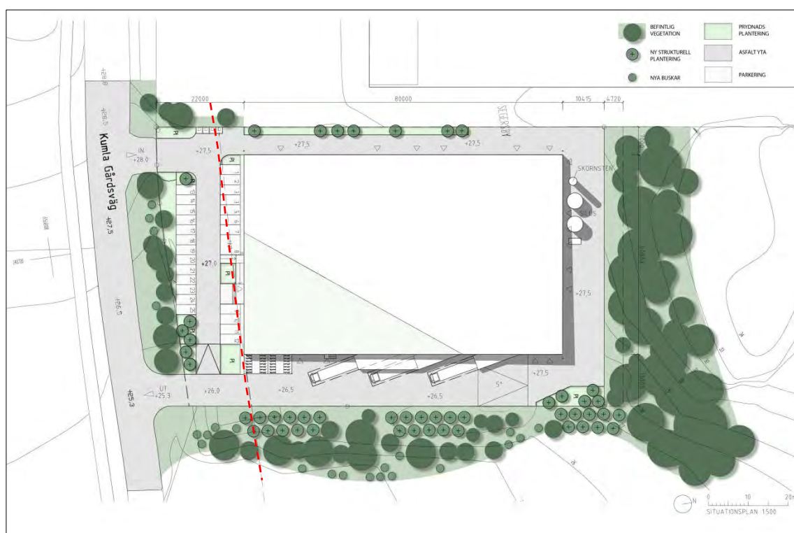
Bild 2: Illustrationsplanen av planförslaget. Skyddsavståndet 25 meter byggnadsfritt från väggkanten från Kumla gårdsväg visas med den rödstreckade linjen.
