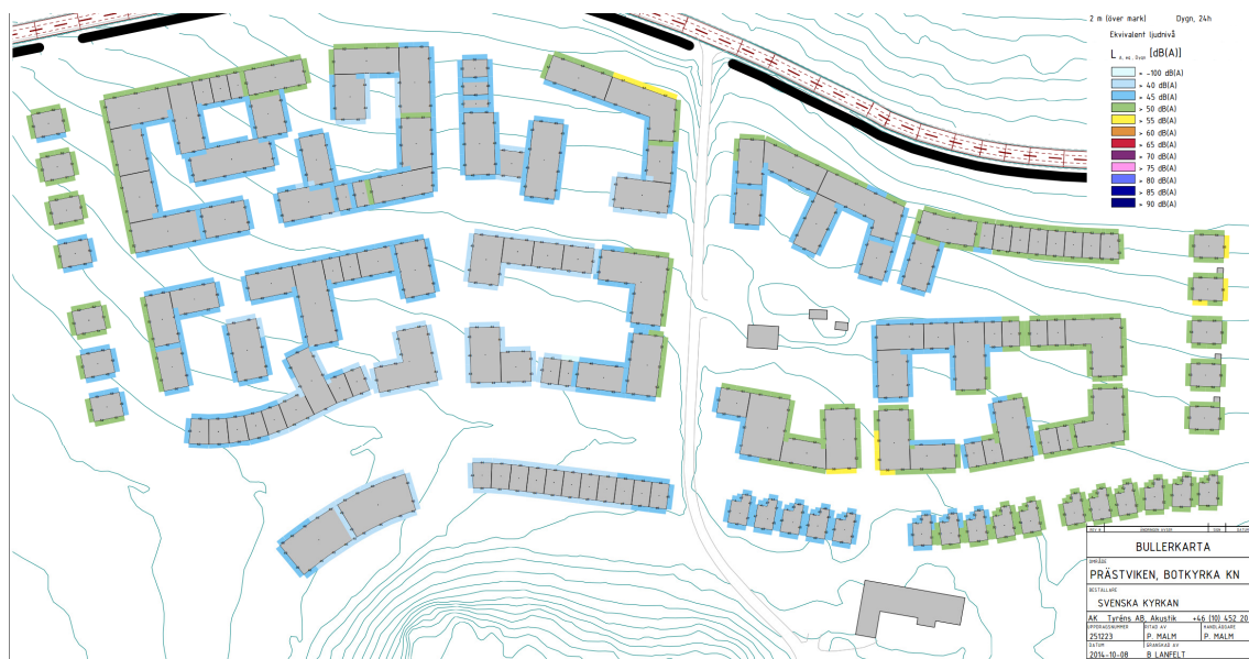
Figur 14. Bullerkarta ekvivalent nivå dB(A) alla våningsplan. Det ljudmässigt sämsta våningsplanet på respektive byggnad visas. Gröna och blå fasader exponeras för nivåer under 55 dB(A). Gula fasader exponeras för nivåer över 55 dB(A).
