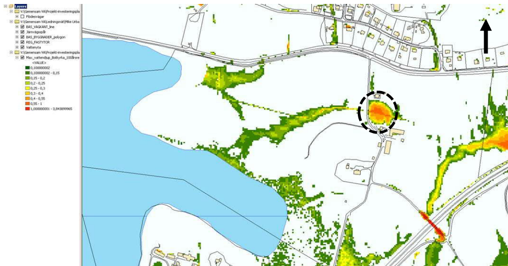
Figur 9. Översiktlig översvämningsskartering för Botkyrka kommun (100-årsregn). Lågpunkt inom planområdet som kan översvämmas i nuläget markerad.
