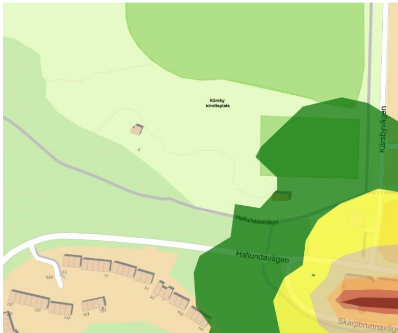
Figur 4. Utdrag från kommunens bullerkartläggning (2006). Ekvivalent ljudnivå från spårtrafik. Mörkgrönt motsvarar 40 - 45 dBA och gult 45 - 50 dBA.
