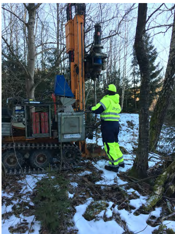
Figur 5.1 Provtagning med borrhandsvagn.
