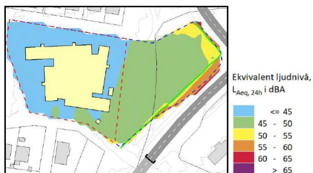
Figur 4. Beräknad ekvivalent ljudnivå 1,5 m över mark för vägtrafik (dygn). Resultatet förutsätter en 2 meter hög skärm (Grön linje).
