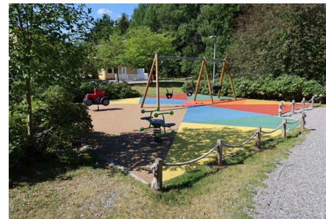
Inspringningsskydd i form av repräcken.
