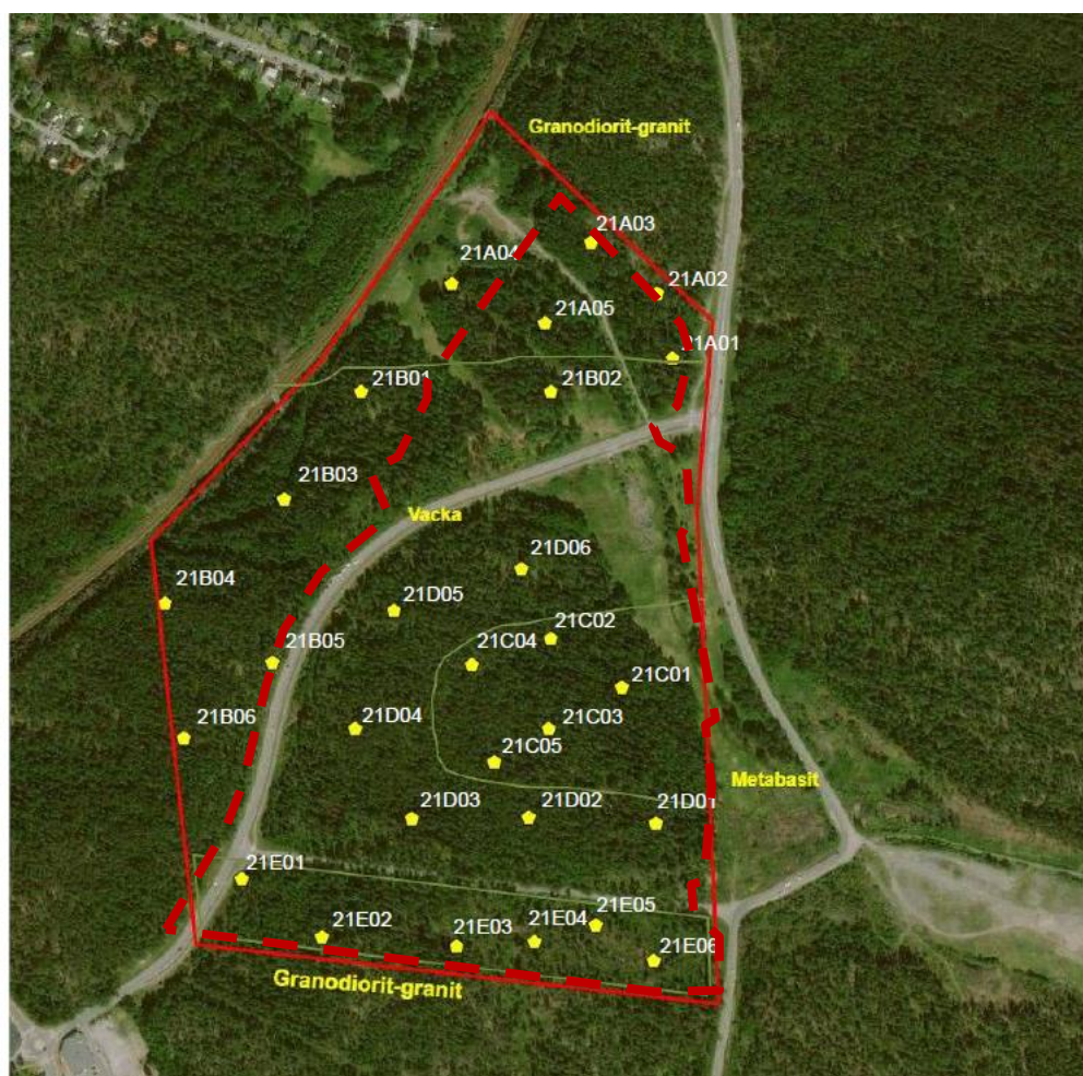
Figur 12, Karta med undersökningsområdet (planområdet markerad med röd streckad linje), borrhovr propositionerna samt huvudsakliga bergarter, enligt SGU markerade. Källa: arcgis.com. 10
