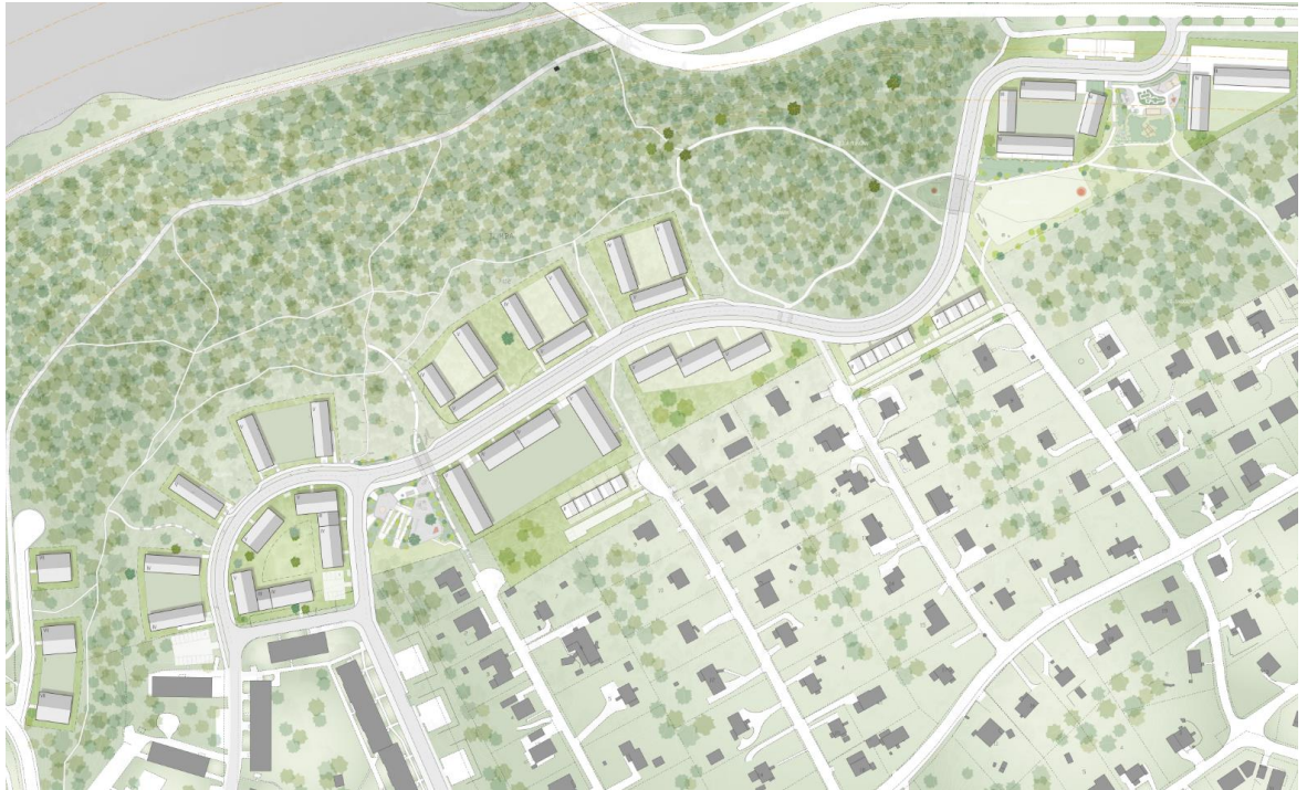
Bild 1. Illustrationsplan med bebyggelseförslaget. Ny bebyggelse är illustrerad i ljusgrått och befintlig bebyggelse är illustrerad i mörkgrått (källa: White Arkitekter).
