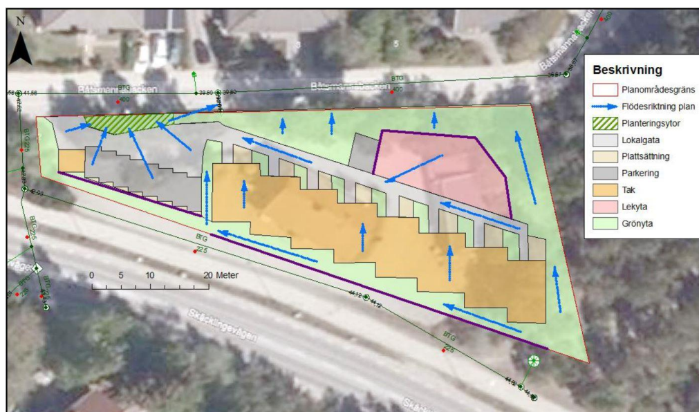
Figur 8 – Föreslagna dagvattenlösningar från dagvattenutredningen. Blå pilar visar det bedömda dagvattenflödet efter exploatering.
