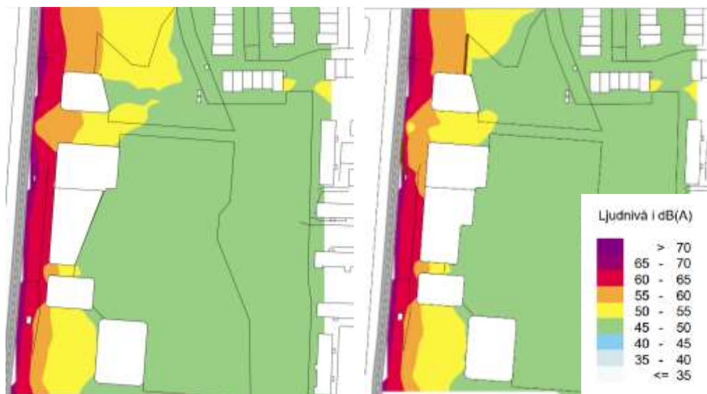
Illustration visar bullerkarteringar efter utbyggnad, t.v. utan bullerskyddsåtgärder, t.h. med bullerskyddsåtgärder. Trafiksiffror ÅDT 2040.
