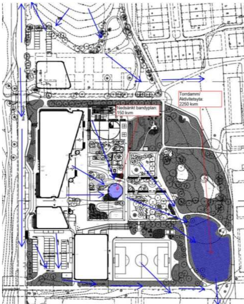
Skiss över situation med ett skyfall så att ytavrinning uppkommer. Föreslagna fördröjningsytor är en nedsänkt bandyplan och aktivitetsyta med dammfunktion.
