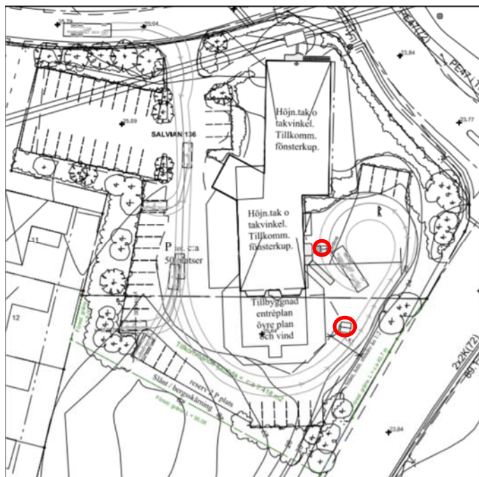
Figur 1 Situationsplan med körspår för sopbil och personbil
