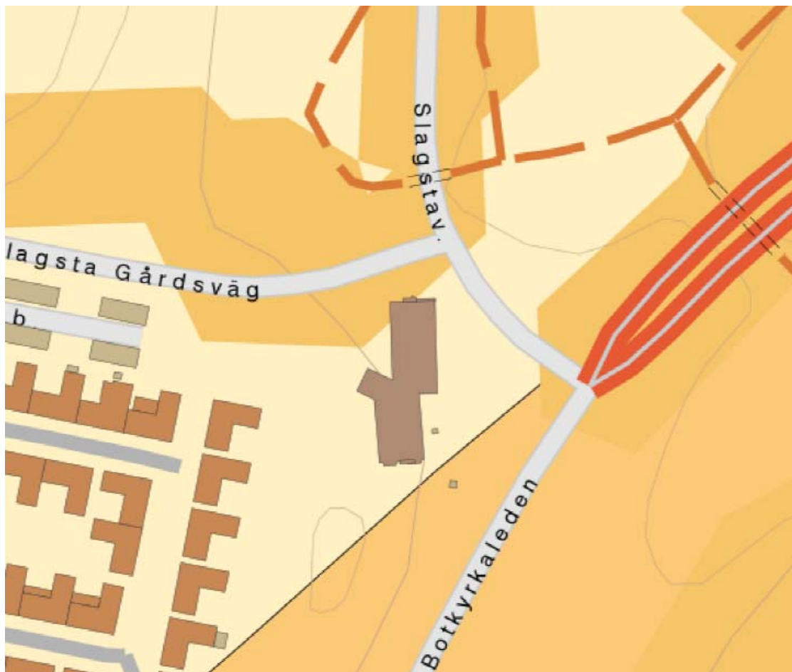
Bild 2. Utdrag ur SGU:s karta "Förutsättningar för skred i finkornig jordart". Det mörkgula området med svartmarkerad gräns sydväst om nuvarande hotellbyggnad är inte ett aktsamhetsområde. Det är däremot det mörkgula området som tangerar hotellbyggnadens nordvästra hörn.
